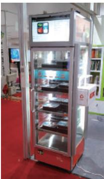
중국에서 현금보다 많이 사용되는 QR코드를 통해 페이스 시스템으로 결제하는 방식으로 음료 및 도시락 등의 간편 먹거리를 판매하는 장비를 전시했다. QR코드로 인증하면 냉장기기 문의 락이 풀리고, 물건을 꺼내고 물을 닫으면 꺼낸 물건들이 자동으로 결제되는 방식이다.
