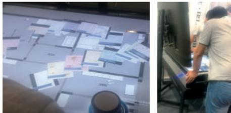
콘텐츠와 연동하여 조작할 수 있는 스마트 테이블이라는 제품으로 전시장에는 모델하우스를 돌아보며 소품·벽지 등을 교체할 수 있는 콘셉트의 제품을 전시했다. 스마트 테이블을 실내건축 데이터와 연동하여 사용자가 쉽게 조작하고 정보를 취득할 수 있도록 했다. 집의 내부를 확인하며 둘러보는 여타 모델하우스 콘텐츠와 비슷하나, 스마트 테이블을 연동하여 터치스크린 위에 손으로 잡고 컨트롤할 수 있는 장치를 이용하는 방식과 손으로 조작하는 방식의 두 가지 입력을 복합적으로 사용하여 직관적이고 편한 조작의 UX를 제공했다. VR 콘텐츠와의 연동 또는 새로운 방식의 콘텐츠 개발에 활용해 보아도 좋을 듯하다.
